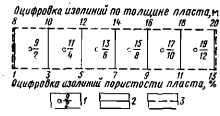
Рис. 31. Модель нефтенасыщенного пласта с закономерно (по линейному закону) меняющимися в пространстве пористостью и эффективной нефтенасыщенной толщиной (план в изолиниях)
