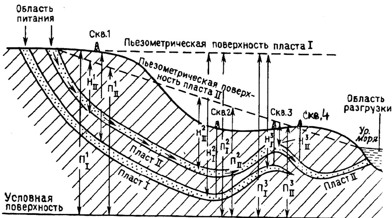
Рис. 15. Схема распределения приведенных давлений ( $\Pi$ ) при горизонтальном и наклонном положении пьезометрической поверхности
