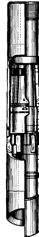
Рис. 23. Наружная труборезка, оборудованная захватом с гидроприводом
