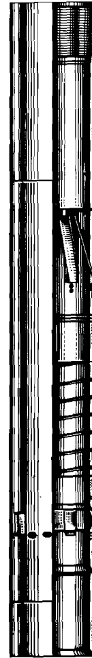
Рис. 22. Наружная труборезка с пружинным захватом, упирающимся в муфту обрезаемой трубы
