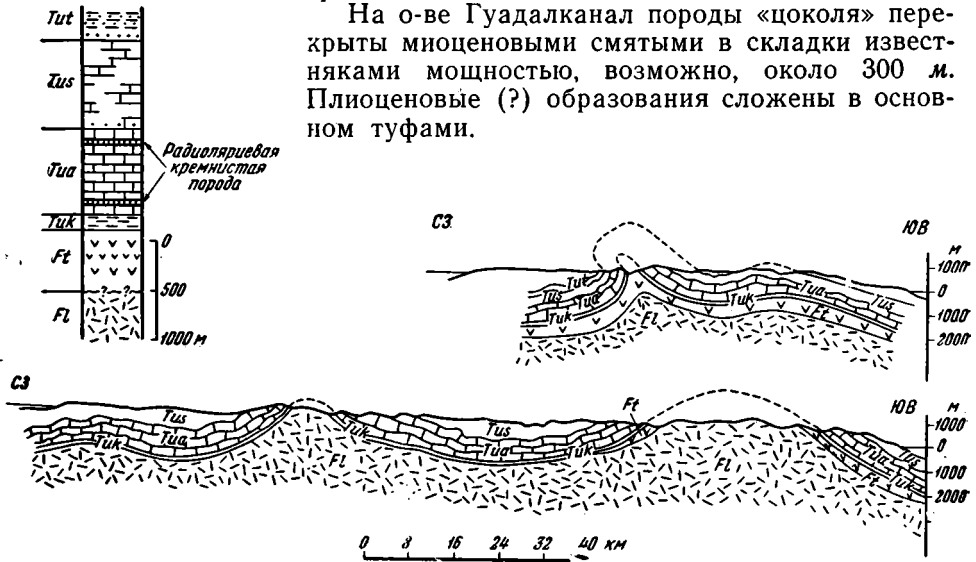
Фиг. 6. Геологические профили через северную половину о-ва Малаита (Соломоновы острова) и стратиграфическая колонка. Из книги «Colonial Geology and Mineral Resources», 1956. Верхнетретичные отложения: Tuk — аргиллиты, Tua — известняки, Tus — мел, Tut — алевролиты. Fl и Ft: более древние лавы и туфы (соответственно)
