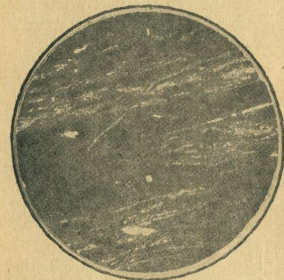
Рис. 6. Характер распределения глинистого вещества в основной массе. (×80).
