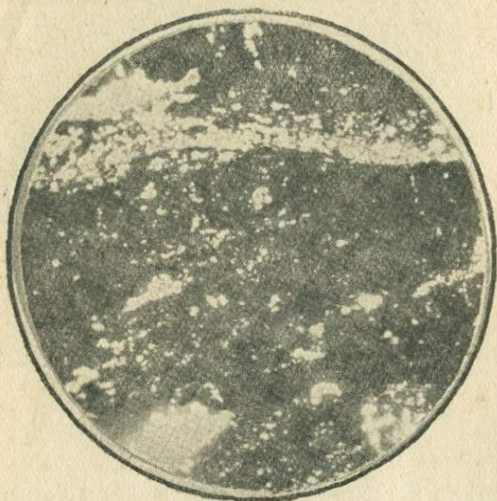
Рис. 4. Микроскопическая картина глинистой разновидности ксиленового типа угля.
