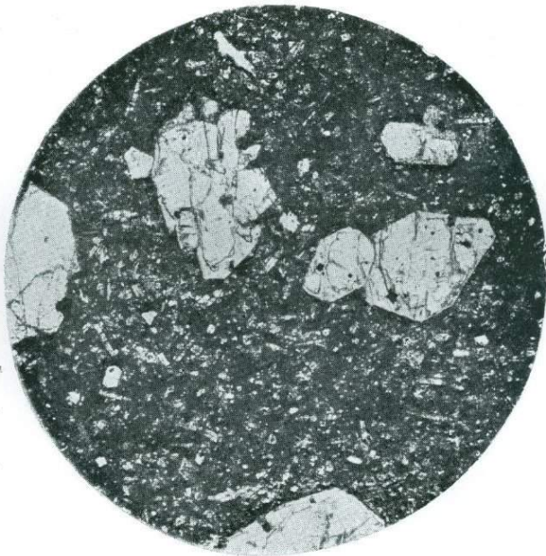
Фиг. 2. Шл. 1375. \times 23 . Никколи \parallel . Пикрит. Порфи́ровые выделения слегка серпентизированного оливина в мелкозернистой основной массе.
