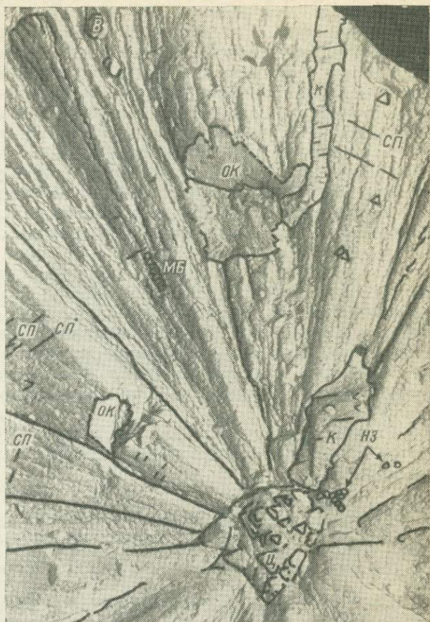
Рис. 6. Тонкая структура индукционного основания сферокристалла настурана. Фото ПЭМ, целлюлозо-угольная реплика.
