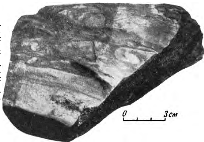
Рис. 24. Ритмичнослоистые красноцветные породы нижней молассы (ордовик). Еринатская мульда. Видна косая слоистость песчаников, структуры подводного оползания в алевролитах и знаки волновой ряби на поверхности слоя алевролитов, резко сменяющегося крупнозернистым песчаником. Верховья р. Еринат
