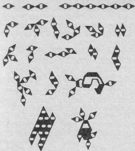
Рис. 33. Слипание минералообразующих частиц серы (зарисовки с микрофотографий стекол образстания; увел. 400).
