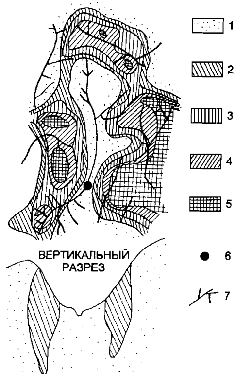
Рис. 2. Распределение суммы коэффициентов минерализации \Sigma K_m (Pb, Zn, Cu, Co, Ag) потоков рассеяния (по С.А. Григорову [40]):
