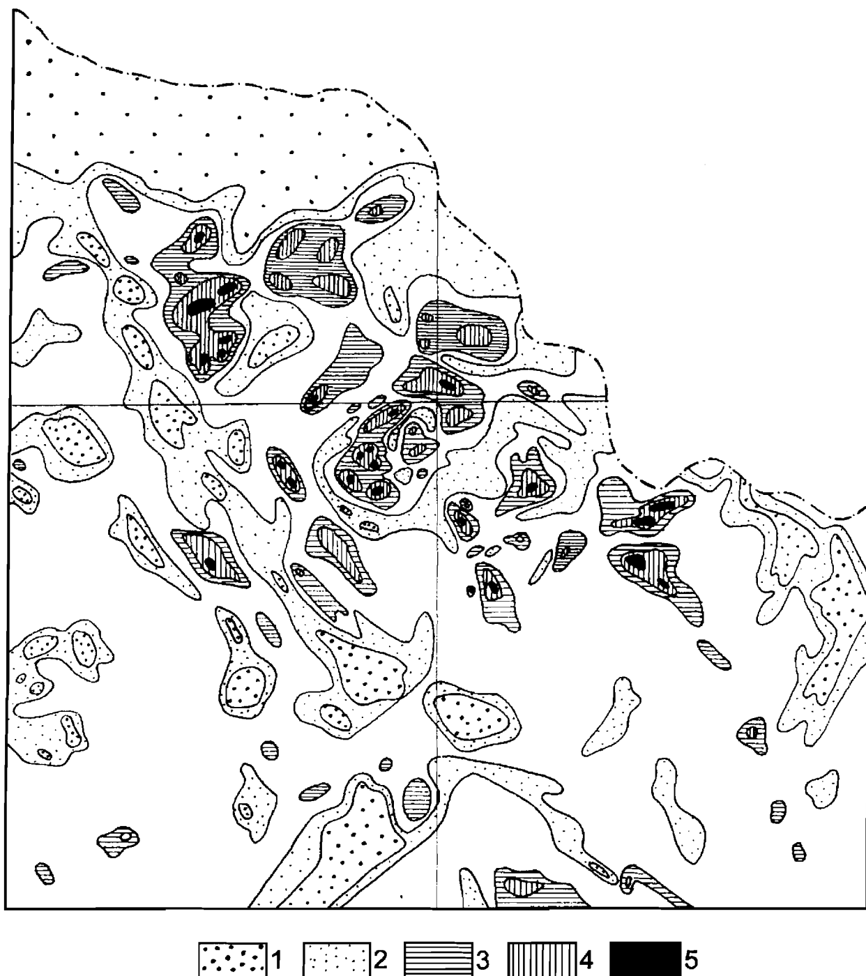
Рис. 69. Геохимическое поле \text{AuAgPbZnMo}/\text{VCrNiMnCo} Чубачинского рудного района. Значения коэффициента ( n \times 10^{-11} ): 1–2 — отрицательных ореолов: 1 — менее 10, 2 — 10–40; 3–5 — положительных ореолов: 3 — 500–2000, 4 — 2000–10000, 5 — более 10000.
