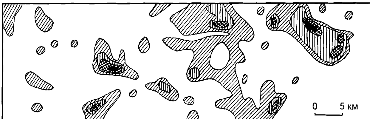
Рис. 80. Геохимическое поле центростремительных элементов AuAgAsWMo:
