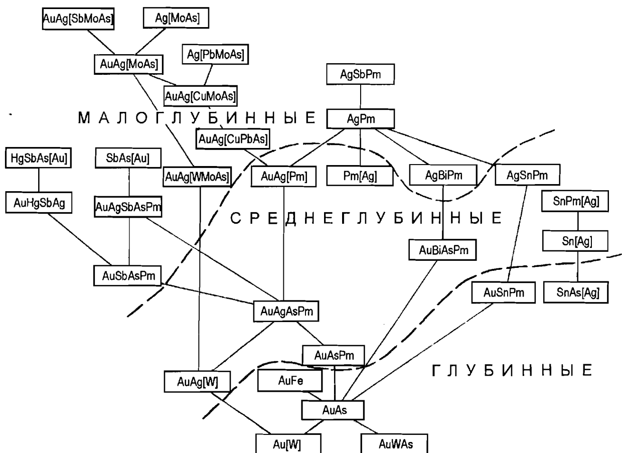
Рис. 61. Структура связей геохимических типов золото-, серебросодержащих проявлений.
