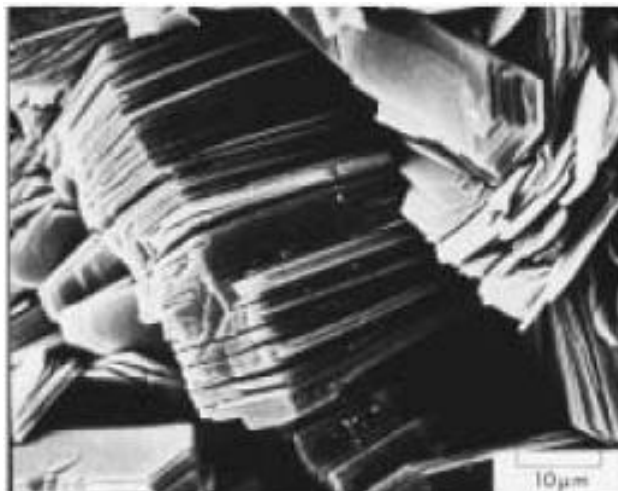
Рисунок 1.9 – Микрофотография кристаллов каолинита [1]
