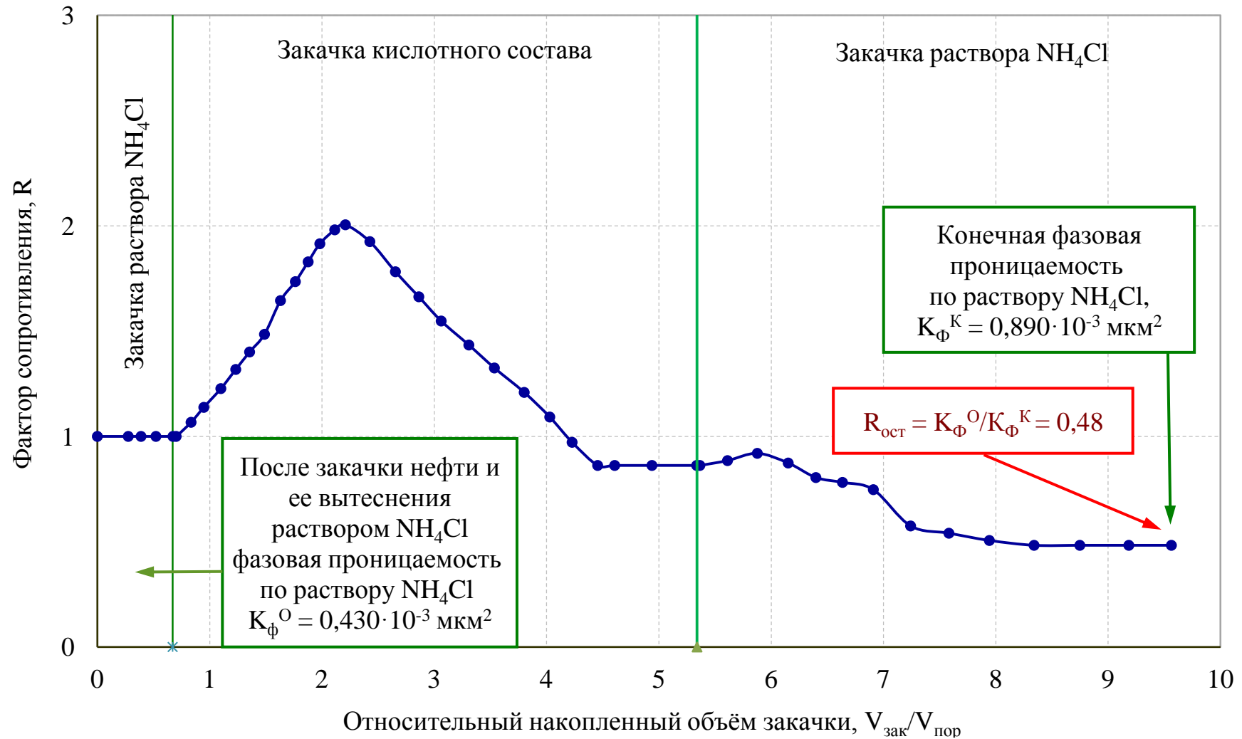
Рисунок 4.2 – Изменение фактора сопротивления ядра с остаточной нефтенасыщенностью после последовательной закачки кислотного состава (образец № 1) и 3 %-ного раствора \text{NH}_4\text{Cl}
