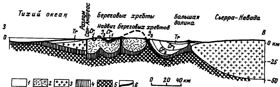
Рис. 65. Схема глубинного строения Западной Калифорнии (Bailey а.о., 1970) 1 - миогеосинклинальные отложения прогиба Грейт-Вэлли (от титона до неогена); 2 - эвгеосинклинальный комплекс Береговых хребтов ("формация Францискан", от титона до турона или коньяка), крапом показаны метаморфизованные породы; 3 - гранитно-метаморфический комплекс Сьерра-Невады (палеозойско-мезозойский); 4 - "базальтовый слой"; 5 - гипербазиты; 6 - разломы
