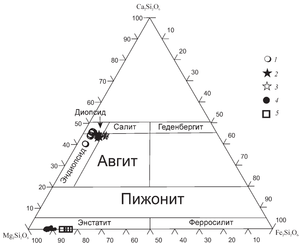
Рис. 2.17. Классификационная диаграмма для пироксенов (Poldervaart, Hess, 1951) Клинопироксены из: 1 – клинопироксенсодержащих гарцбургитов, 2 – кумулятивных перидотитов, 3 – плагиоклазовых перидотитов и габбро; ортопироксены из: 4 – реститовых перидотитов, 5 – вебстеритов.
