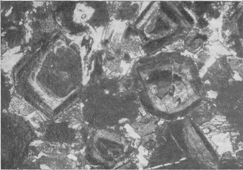
Рис. 2. Скопления кристаллов зонального эпидалита в альбитизированном сивените. Шлиф 104-п, увеличение 70, с анализатором
