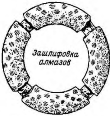
Рис. 26. Виды износа однослойных (А), многослойных (М) и импрегнированных (И) коронок (см. табл. 29). См. продолжение.
