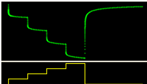
Рис. 9.А.14 – Исследование скважины методом противодавления
