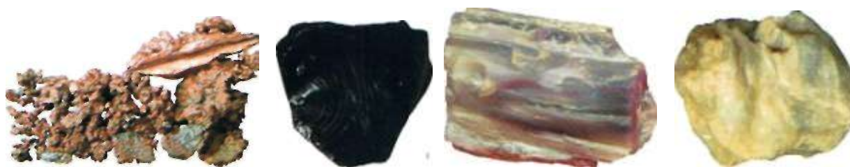
Рис.31. Виды изломов. Занозистый (медь), раковистый (обсидиан, опал), неровный (тальк)
