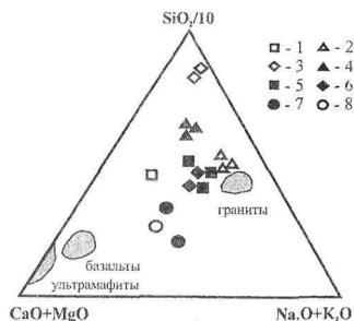
Рис. 3. Диаграмма для реконструкции источников сноса [Тейлор и др., 1988] для терригенных отложений байкальской серии.
