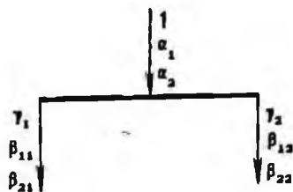
Рис. 1.4. Схема разделительной операции, описываемая переопределенной системой уравнений баланса
