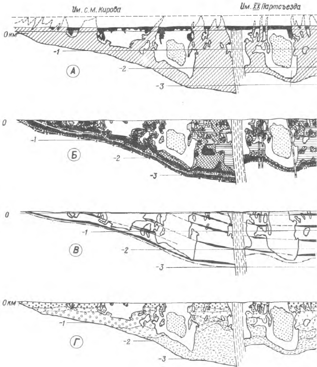
Рис. 29. Вертикальная зональность Криворожского бассейна (продольные проекции А – размещение эпигенетических железорудных формаций (римские цифры справа в кружках – эрозионная зональность в изолиниях мощности залежи богатых руд саксаганского типа; В – зоны максимумов; железистые кварциты: 1 – неокисленные, 2 – окисленные, 3 – эгиринизированные; 4 – дайки дисперсногематит-мартитовые богатые руды: 8 – пористые полурыхлые, 9 – сцементированные гетинитом, 13 – с каолинитом и пойкилитовым кварцем, 14 – с шамозитом, серпентином и тальком, 15 – более 40; 19 – оси зон максимумов рудных площадей; контакты: 20 – пород и руд; пластовые зоны, 27 – контуры размытой час
