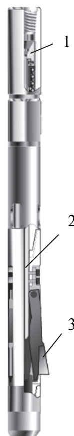
Рис. 5.30. Вырезающее устройство типа УВУ: 1 – поршень; 2 – толкатель; 3 – резец
