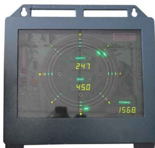
Рис. 3.21. Табло оператора телеметрической системы «Корвет»: указаны текущие значения азимутального угла скважины – 247°, зенитного угла скважины – 45° и глубина скважины – 1568 м
