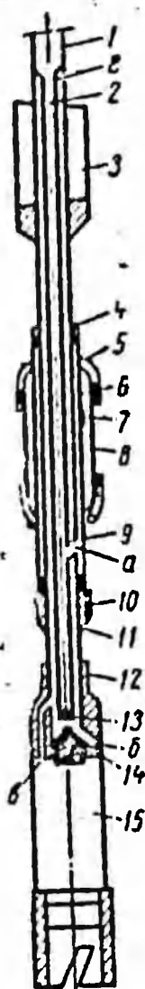
Рис. 36. Снаряд с гидравлическим пакером 1—бурильная труба; 2—центральная трубка; 3—шламовая труба; 4—сальник; 5—прокладка; 6—муфта; 7—клапан; 8—пакер; 9—труба; 10—муфта; 11—конус; 12—переходник; 13—клапан; 14—пружина; 15—колонковый снаряд
