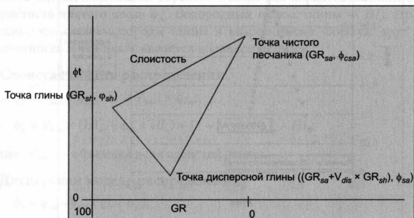
Рис. 5.6.3. Общая пористость ( \phi_t ) в зависимости от данных GR-каротажа для слоистой и дисперсной глины
