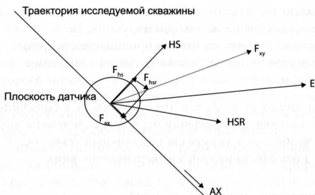
Рис. 12.1.1. Поля в системе координат скважины
