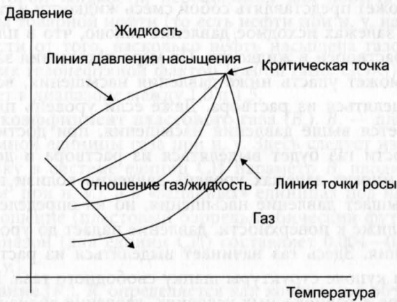
Рис. 11.2.1. Диаграмма «давление-температура» для двухфазной системы
