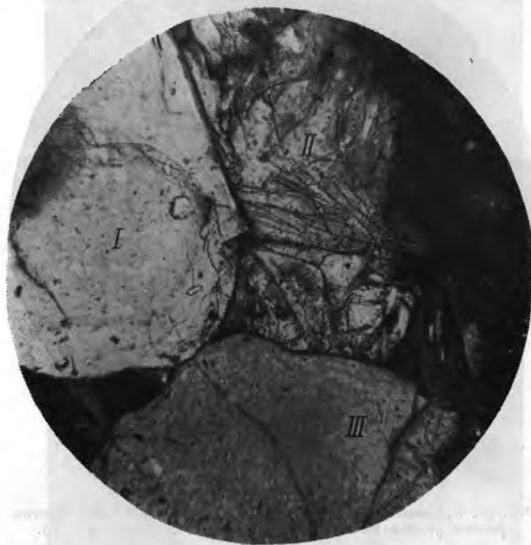
Рис. 87. Приспособление зерен I, II, III вследствие смещения (увеличение \times 200 , николи +).
