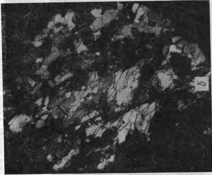
Рис. 51. Бiotит-гранатовый гнейс (обр. 853). Вторая группа по составу, первая по изменности. В исходном шлифе образца (а) наблюдается слабая изменность вторичными процессами (калцинизацией, серпентинизацией). В шлифе (б) образца, деформированного до разрушения при всестороннем сжатии 4500 \text{ кг/см}^2 и комнатной температуре (остаточная деформация 5,3%), в зоне сдвига, проходящей под углом 30^\circ к направлению деформирующего усилия и имеющей ширину около 4 мм, наблюдаются изгиб листочков биотита и резкое облачное их угасание, а также повышенная трещиноватость и облачное угасание зерен кварца и полевого шпата.
