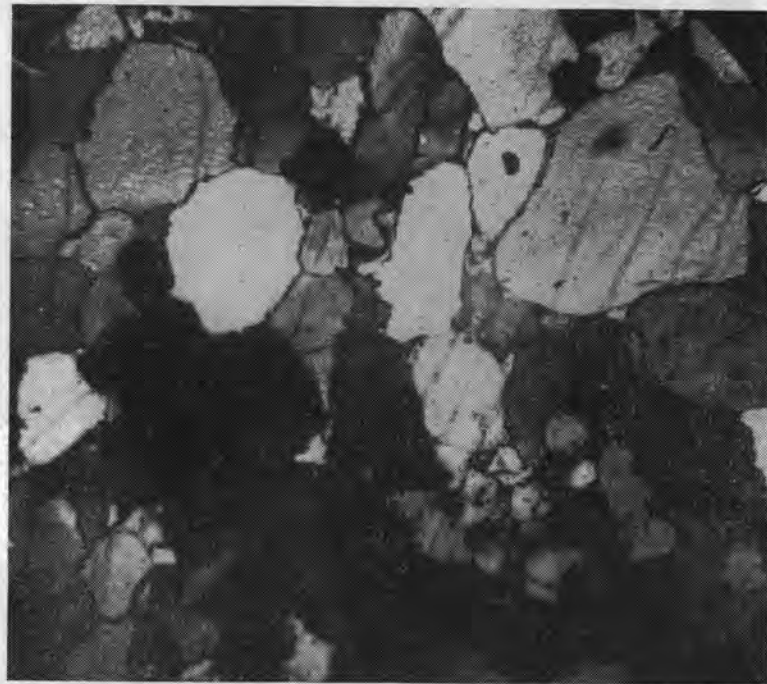
Рис. 46. Шокшинский кварцит. Первая группа по составу и измененности. На шлифе кварцита, деформированного при напряжении, близком к разрушающему, в условиях всестороннего сжатия \sigma_{0p} = 4500 \text{ кг/см}^2 видимых изменений в структуре не наблюдается.
