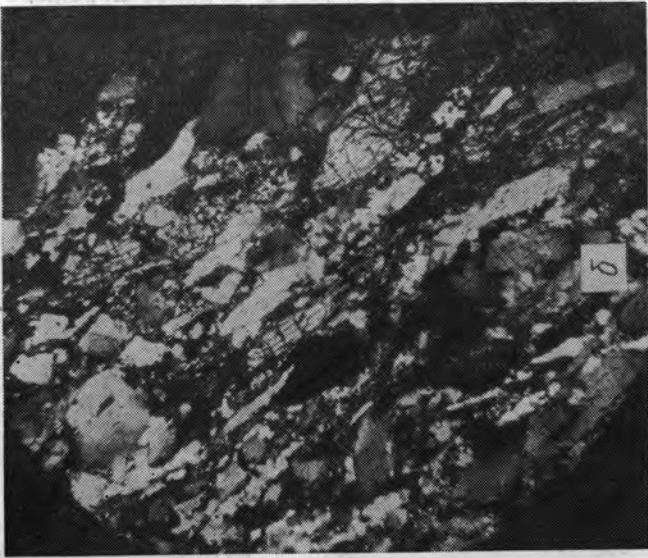
Рис. 47. Катаклизит чарнокита (обр. 459). Первая группа по составу, четвертая по изменности. В исходном шлифе (a) наблюдаются признаки сильного катаклаза. В шлифе (б) образца, деформированного до разрушения при всестороннем сжатии 4000 \text{ кг/см}^2 и температуре 200^\circ \text{C} , вблизи зоны скола наблюдается сильная раздробленность и трещиноватость минералов.
