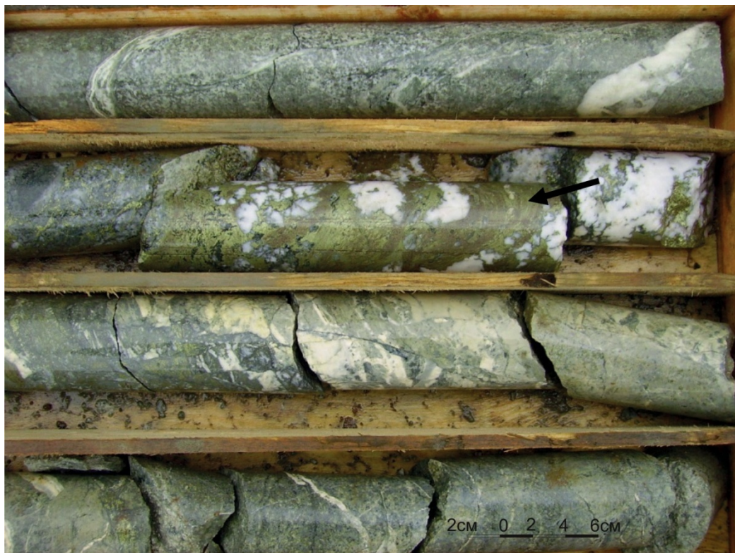
Рис. 11. Преобладание халькопирита в карбонат-кварц-сульфидной жиле рудного тела Новое зоны Меридиональной. Скважина № 8, интервал 120-132 м.
