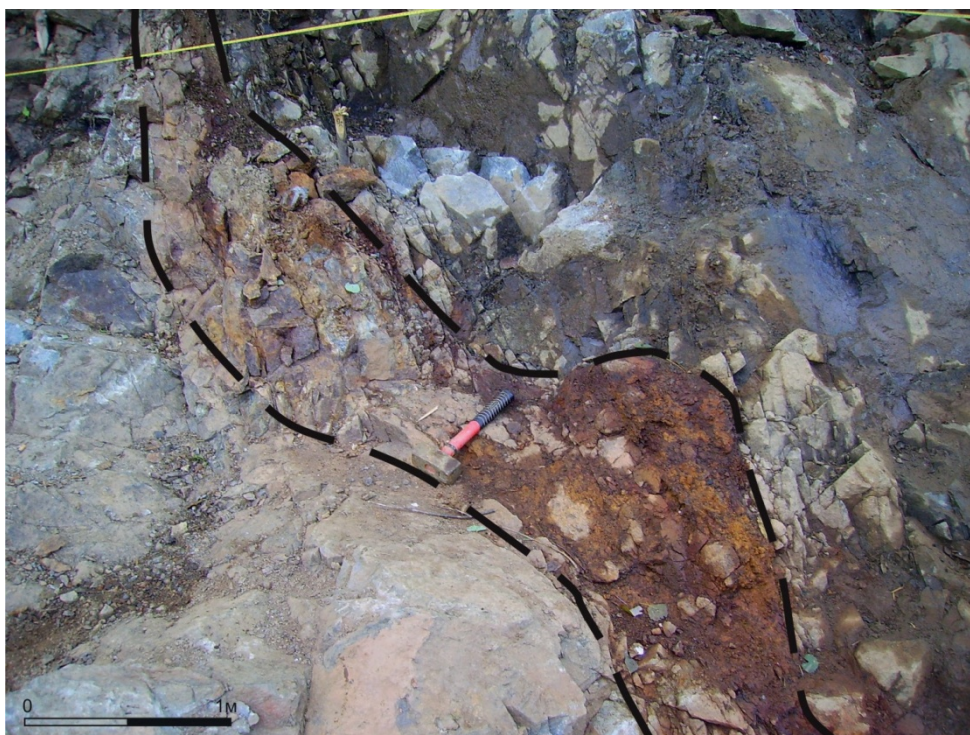
Рис. 10. Окисленные руды Дайкового рудного тела зоны Меридиональной. Канавка 15, интервал 37.0-40.0 м.
