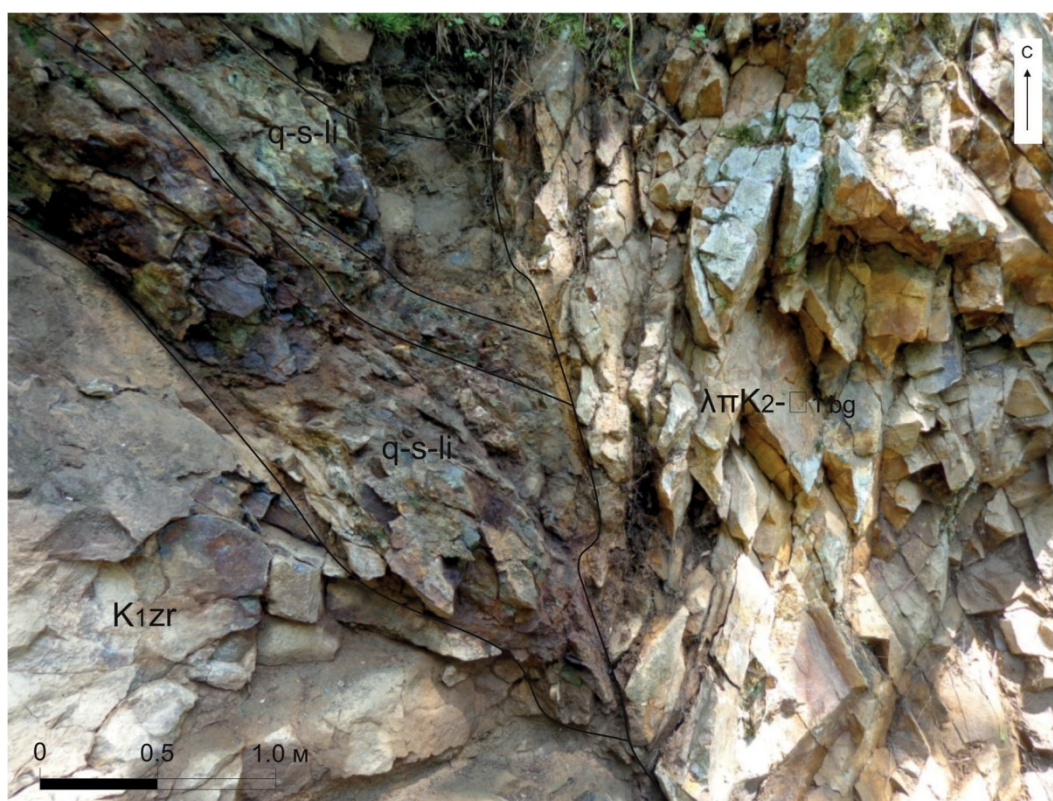
Рис. 16. Рудное тело кварц-лимонит-халькопирит-арсенопиритового состава (q-s-li), залегающее в алевролитах Журавлевской свиты ( K_1zr ) секут риолиты Богопольской свиты ( \lambda\lambda K_2 - P_1bg ). Расчистка Р-61.
