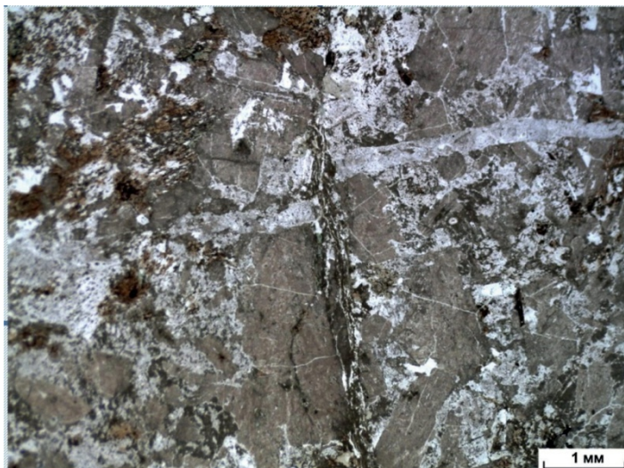
Рис. 29. Смещение карбонатного прожилка при пересечении его прожилком хлорит-лейкоксен-кварцевой ассоциации. Стереоскопический микроскоп Leica-E. Образец 24- 94.
