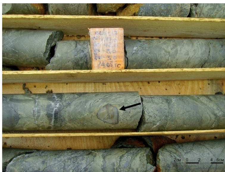
Рис. 3. Кварцевая галька в метасоматически измененных конгломератах Журавлевской свиты. Скважина № 13, интервал 39.0-42.0 м.
