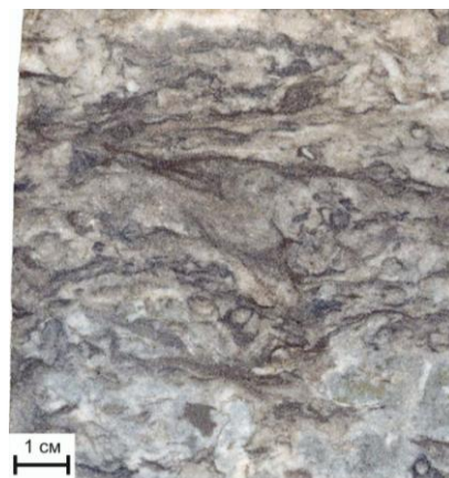
Рисунок 5.28 – Алевролит мелкозернистый, глинистый, текстура горизонтально-пологоволнистая, нарушена биотурбацией. Скв. 457 Западно-Грачевская, глубина 3116,3 м
