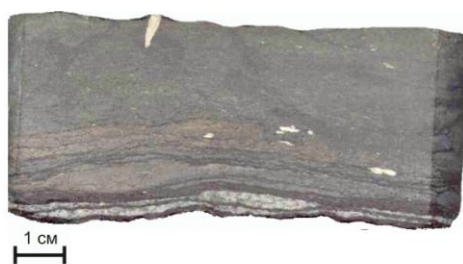
Рисунок 5.24 – Алевро-глинистая порода, сильно углистая, слоистой текстуры. Скв. 459 Западно-Грачевская, глубина 3158,56 м
