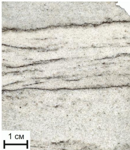
Рисунок 5.9 – Песчаник с полого-волнистой слоистостью. Скв. 2 Березовская, глубина 2409,27 м
