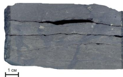
Рисунок 5.25 – Алевро-глинистая порода, сильно углистая. Скв. 50 Куликовская, глубина 3391,0 м
