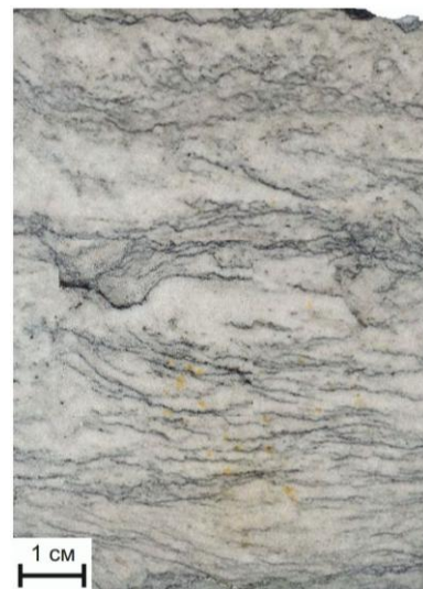
Рисунок 5.18 – Алевролит крупнозернистый, песчанистый, с пологоволнистой, горизонтальной слоистостью, подчеркнутый скоплениями углистого материала. Скв. 347 Ново-Малаховская, глубина 2517,43 м
