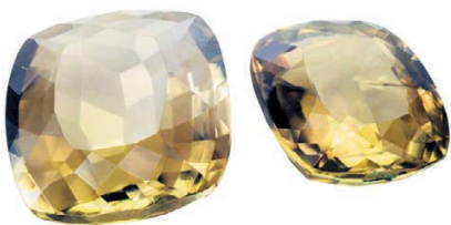
Радужные разводы в камнях — трещины, появившиеся в результате чистки ультразвуком
