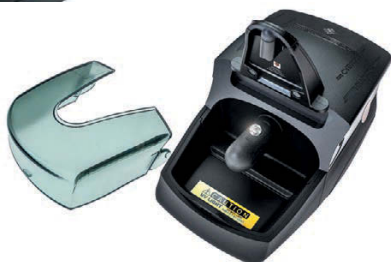
Прибор для обнаружения синтетических бриллиантов
