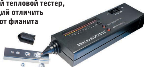
Продвинутый двухрежимный тестер, позволяющий различать бриллианты, фианиты и муассаниты
