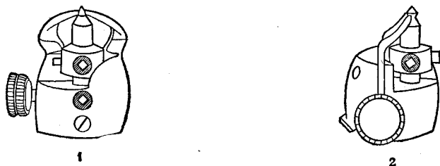
Рис. 105. Механический доп: 1 — вид под прямым углом к прижимному винту, 2 — вид вдоль прижимного винта.
