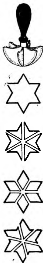
Рис. 10. Примеры разбиения фигуры, обладающей осью 6-го порядка, резакон, ось которого совмещена с осью симметрии фигуры
