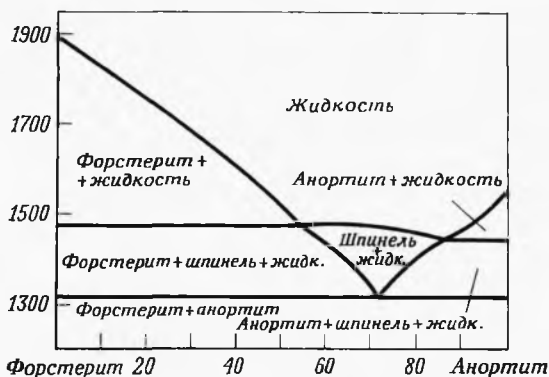
Фиг. 90. Псевдобинарное сечение Mg_2SiO_4-CaAl_2Si_2O_8 [97].
