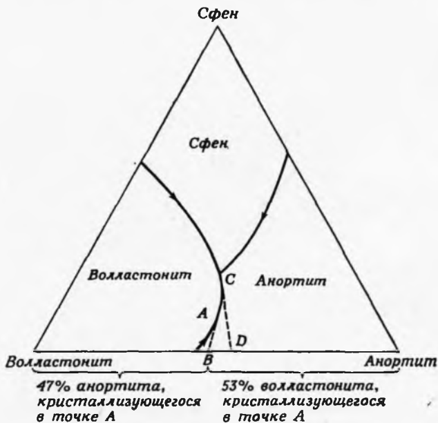
Фиг. 21. Применение правила касательной для определения соотношения фаз, кристаллизующихся вдоль пограничной кривой.
