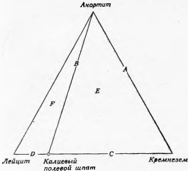
Фиг. 32. Расположение линий Алькемаде в системе \text{CaAl}_2\text{Si}_2\text{O}_8\text{—KAlSi}_2\text{O}_6\text{—SiO}_2 . Вспомогательные треугольники, на которые расчлениют систему линии Алькемаде, используются для определения ассоциации кристаллических фаз.
