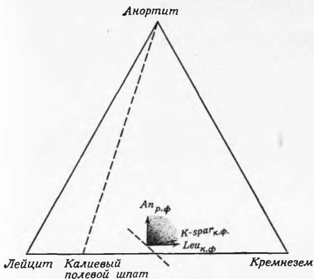
Фиг. 35. Другой случай неправильного расположения векторов, предполагающий плавление анортита и кристаллизацию лейцита и калиевого полевого шпата.
