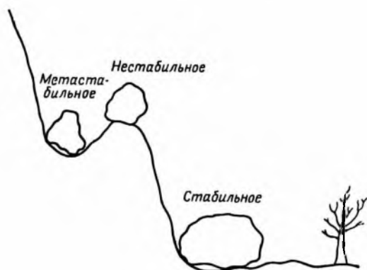
Фиг. 1. Различный характер равновесия, рассматриваемого относительно уровня наиболее стабильного состояния.
