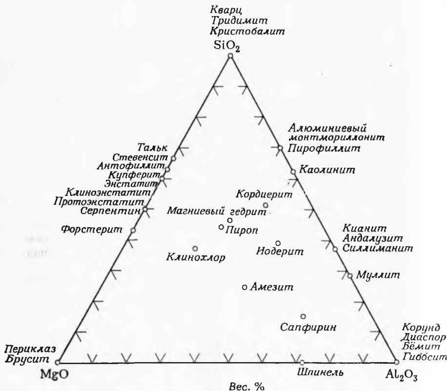
Фиг. 172. Система MgO-Al_2O_3-SiO_2 при давлении H_2O 2 кбар.
