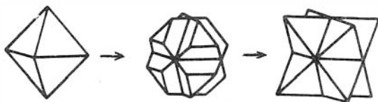
Рис. 2. Схема трансформации кристалла октаэдрического габитуса в антискелет
