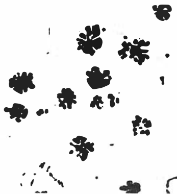
Рис. 2. Характерные формы выделений перекристаллизованного графита, система Ni-C
