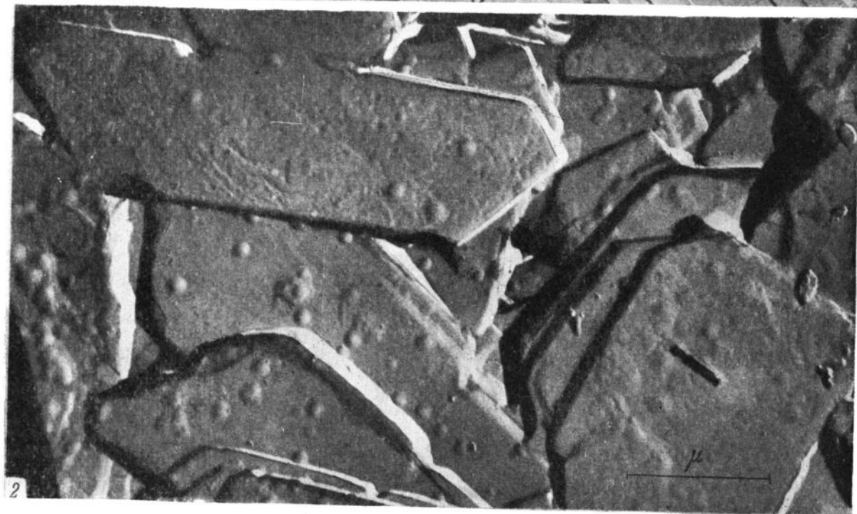
1. Уранопилит. Угольная реплика, оттененная платиной 2. Вспучивание кристаллов уранопилита под влиянием нагрева при нанесении реплики
