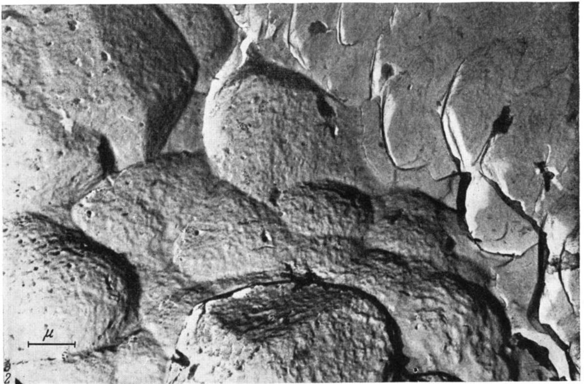
1. Поперечное сечение микропочки смолки. Целлюлозо-угольная реплика 2. Контакт смолки с вмещающей жильной массой. Целлюлозо-угольная реплика
