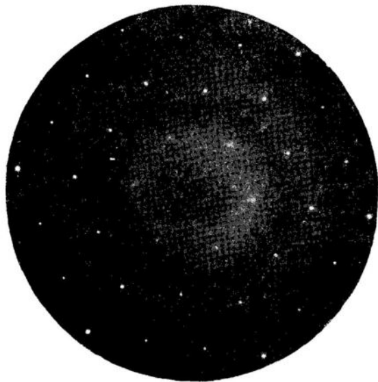
Фиг. 62. Дифракционная картина от кристалла каолинита
