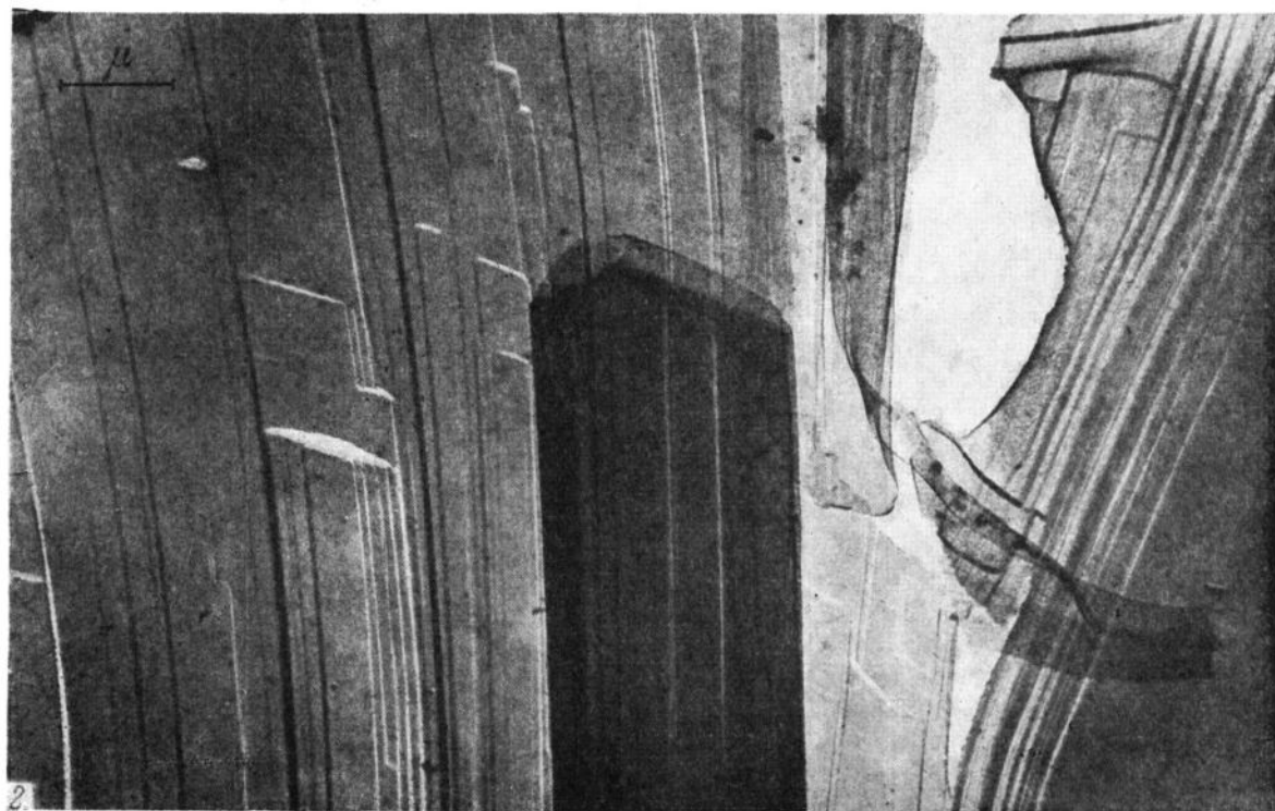
1. Индукционная поверхность кристаллов топаза. Угольная реплика. Оттенок платиной 2. Ураномолибдат. Угольная реплика. Оттенок платиной
