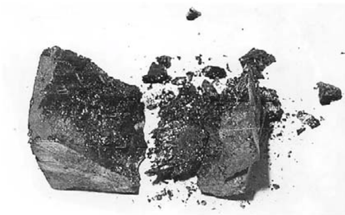
Рис. 2.16. Вид разрушения образца угля марки «Т» [Алексеев и др., 1983] при обобщенном сдвиге ( \mu_\sigma = 0 , \sigma_0 = -20,6 МПа)
