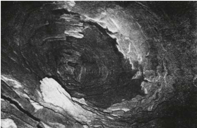
Рис. 1.2. Форма полости при выбросе породы в выработку [Зорин, 1978]
