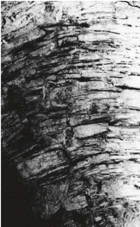
Рис. 1.3. Слоистость боковой стенки полости в забое шахты Южного горного бассейна (Германия) [Eckart, et al., 1966]
