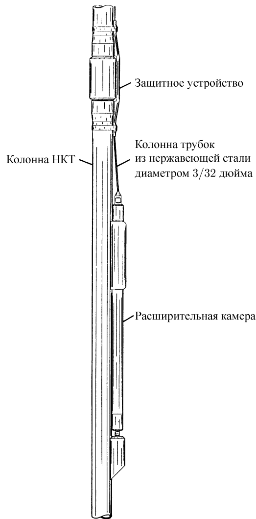
Рис. 13.9. Манометр Сперри-Сан Пермогейдж в виде установки на опоре. Рисунок предоставлен компанией Сперри-Сан.
