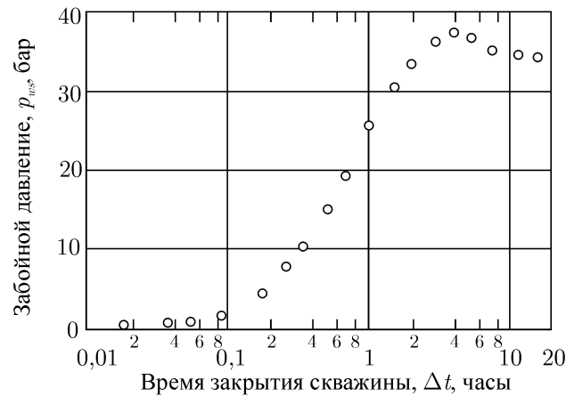
Рис. 2.13. Внешний вид КВД, вызванный фазовым переходом в стволе скважины. По Мэттьюзу и Расселу [1].
