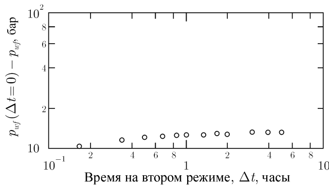
Рис. 7.10. Билогарифмический график данных исследования скважины методом падения давления на двух режимах к примеру 7.3. Закачка воды в заводняемый пласт.
