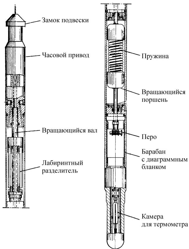
Рис. 13.5. Прецизионный глубинный манометр Лойтерт. Рисунок предоставлен Фридрихом Лойтертом.
