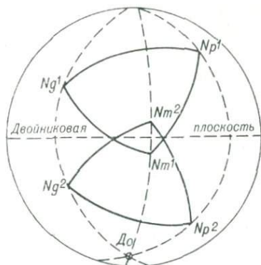
Рис. 39. Способ графического нахождения двойниковой оси и двойниковой плоскости.
