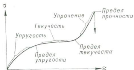
Рис. 103. Кривая стресс—деформация с пределом текучести.
