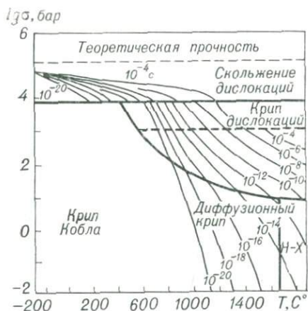
Рис. 112. Карта установившейся деформации агрегата оливина [70].
