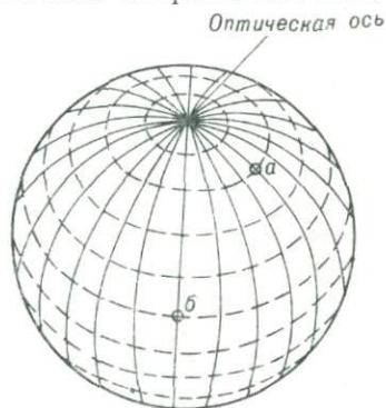
Рис. 14. Шар Бера для одноосного кристалла.
