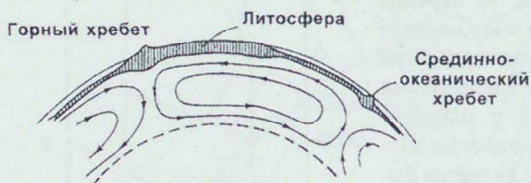
Рис. 8.7. Модель тепловой конвекции в верхней мантии (по П. Шарма). Конвективные потоки поднимаются вблизи океанических хребтов и отдают тепло, растекаясь в направлении континентов
