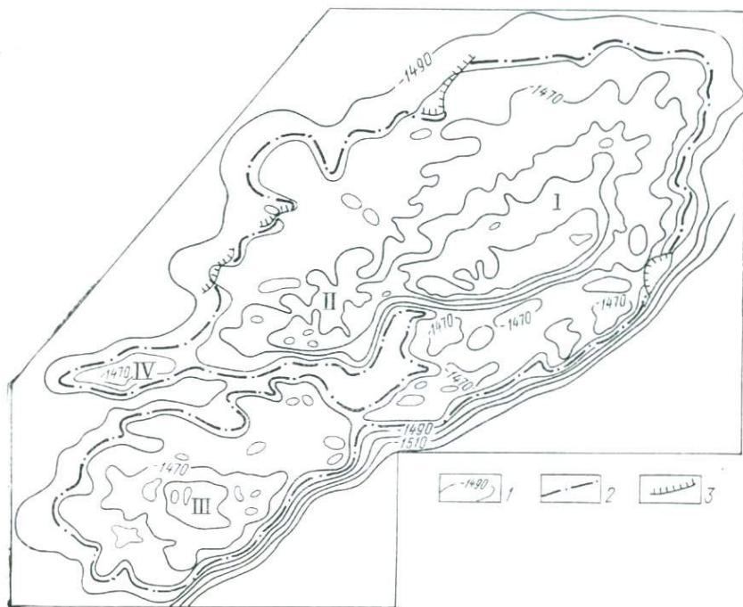
Рис. 13. Пример соотношения структурного плана продуктивного горизонта, контура нефтегазоносности и выделяемых месторождений нефти [26].
