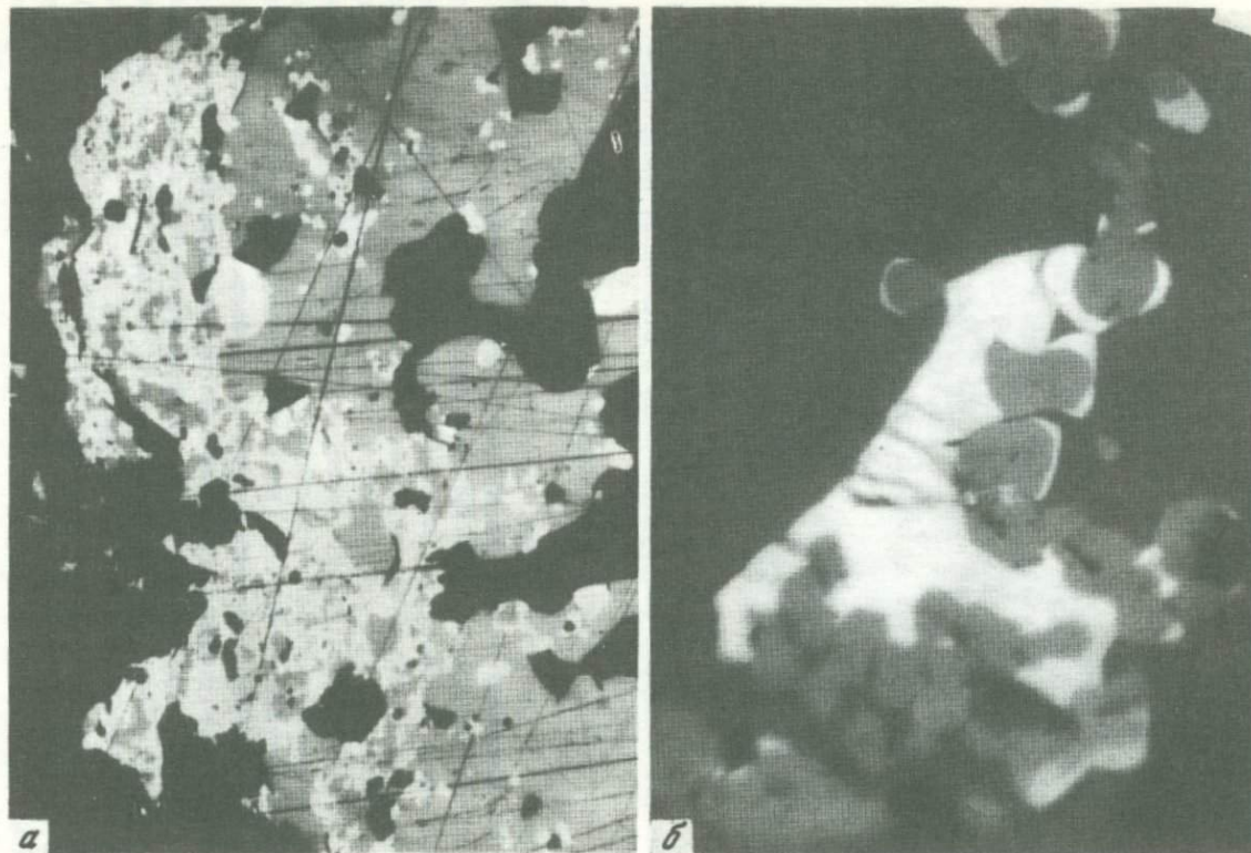
Фиг.37. Формы выделения и ассоциации колусита, а - скопление мелких вкрапленников колусита (белое) в борните (серое). Черное - кварц. б - сферолиты колусита (серое) в сростке с галенитом (белое) среди борнита (темное). Полир, шлифы. Увел. 200 и 1000 (в иммерсии)
