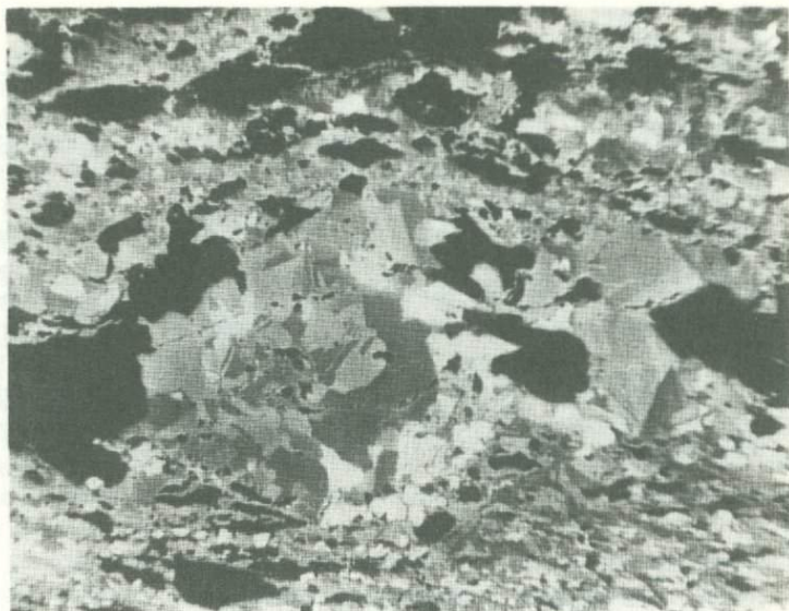
Фиг.59. Перекристаллизованное очко сфалерита среди его тонкозернистого агрегата (протравлено) в сланцеватой руде. Черные линзы – серицит. Полир. шлиф. Увел.40
