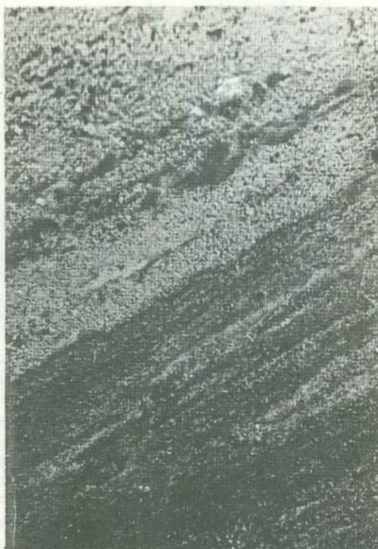
Фиг. 48. Сплошная руда с чередованием халькопирит-пиритовых (светлое) и пирит-сфалеритовых (темное) полос. Полир.штуф. Увел.6
