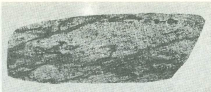
Фиг.32. Наложенная прожилковая плосчатость борнита (темное) в пирите (светлое). Полир.штурф. Натур.вел.
