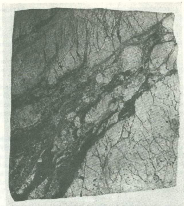
Фиг.29. Сплошная пиритовая руда с зоной дробления. Раздавленный пирит (светлое) сцементирован блеклой рудой и сфалеритом. Черное - нерудные. Полир. штуп. Натур. вел.
