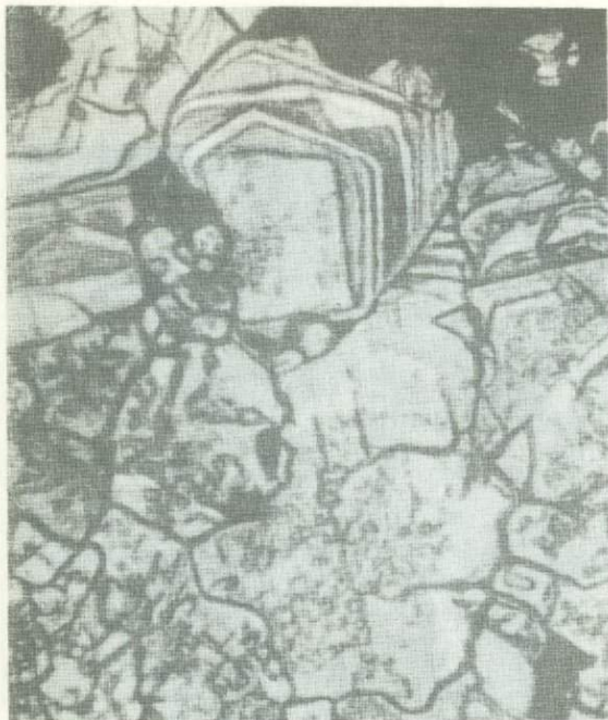
Фиг.8. Сплошная пиритовая руда. Протравлено. В одном зерне трижды меняется форма зон роста. Часть зерен утратила зональное строение. Полир. шлиф. Увел.200
