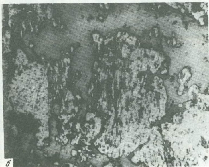
Фиг. 17. Особенности замещения кристаллов (а) и сплошных агрегатов (б) пирита (белое) борнитом (темное). Серое — халькопирит. Полир. шлифы. Увел. 340 и 200
