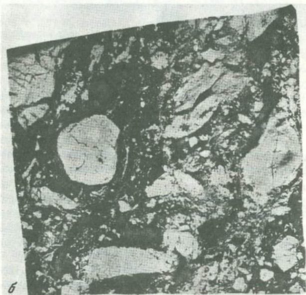
Фиг.60. Брекчиевидная (а) и брекчиевая (б) текстуры пиритовой руды. В цементе кварц с мелкими зернами и обломочками пирита. Полир. штуфы. Натур.вел.
