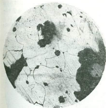
Рис. 17. а — структура частичной перекристаллизации зонального золота: возникновение пятнистых структур и мелкой, близкой к полиэдрической, зернистости. Монтированный аншлиф, протравленный раствором \text{Cr}_2\text{O}_3 в \text{HCl} . Увел. 30;
