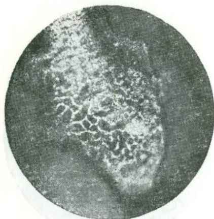
Рис. 22. «Сотовые» структуры распада твердого раствора самородного золота. Монтированный аншлиф, протравленный раствором \text{Cr}_2\text{O}_3 в \text{HCl} . Увел. 300. Снимок В. В. Крыловой.
