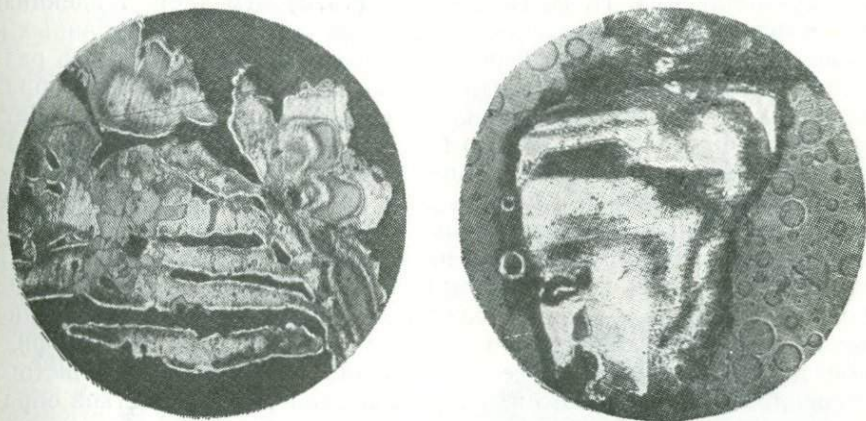
Рис. 10. Зональное внутреннее строение золота из субвулканического месторождения. Реликты раннего золота приобрели мелкозернистое близкое к полиэдрическому строение. Монтированный аншлиф, протравленный раствором \text{Cr}_2\text{O}_3 в \text{HCl} . Увел. 70.
