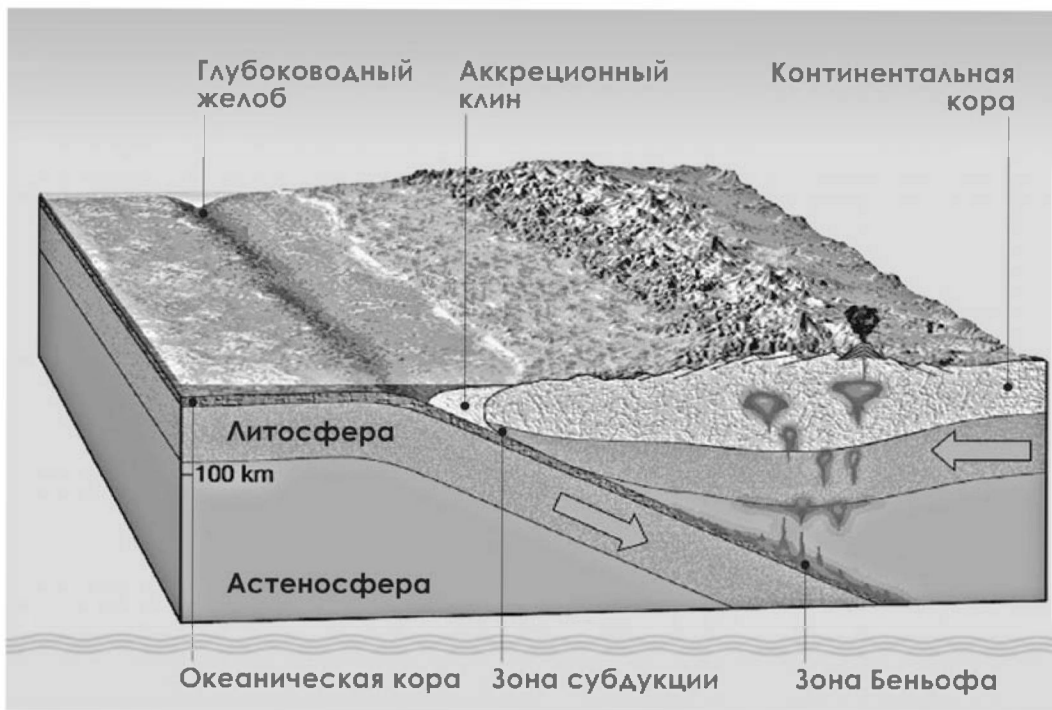
Рис. 5. Основные структурные элементы зон поддвижения океанической литосферы под континентальную (по А.А. Андрееву)
