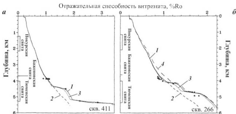
Рис. 56. Вычисленные (линии) и измеренные (звездочки) значения отражательной способности витринита в современных разрезах Уренгойского месторождения скв. 411 и 266: 1 – профиль, вычисленный с учетом всех эффектов; 2 – профиль, вычисленный без учета эффекта гидротермального прогрева; 3 – вычисления без учета сокращения теплопроводности от присутствия дисперсного ОВ в породах; 4 – вычисления в варианте, когда формирование УВ скоплений началось 85 млн лет назад и завершилось 60 млн лет назад [16, 88]
