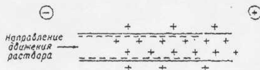
Рис.25. Схема образования фильтрационной разности потенциалов на концах капилляра.
