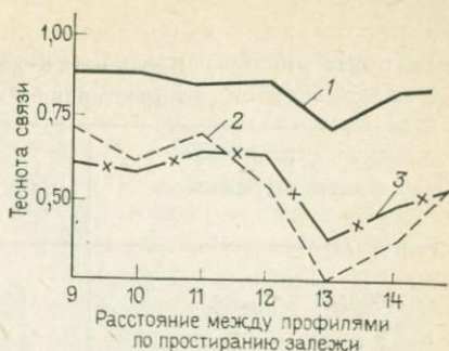
Рис. 39. Диаграммы изменения тесноты связей между содержаниями компонентов по простиранию Основной залежи Иртышского месторождения для пар свинец — цинк (1), свинец — медь (2), цинк — медь (3)
