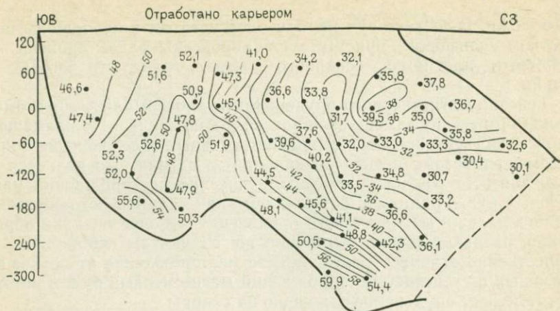
Рис. 24. Результаты геометризации содержаний железа в залежи № 1 Евстунинского месторождения (вертикальная проекция)
