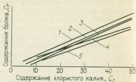
Рис. 36. Графики зависимости и уравнения регрессии содержаний брома и хлористого калия в сильвинитах Верхнекамского месторождения.
