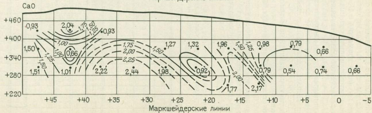
Рис. 19. Графики распределения содержаний компонентов в рудном теле Главного Сарановского месторождения.
