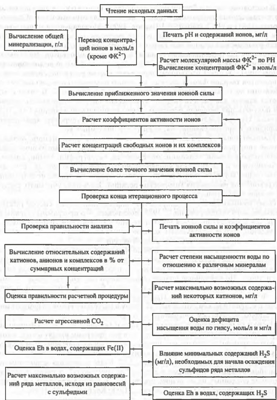
Рис. 2.17. Блок-схема алгоритма программы серии MIF, по [Соломин, 1988]
