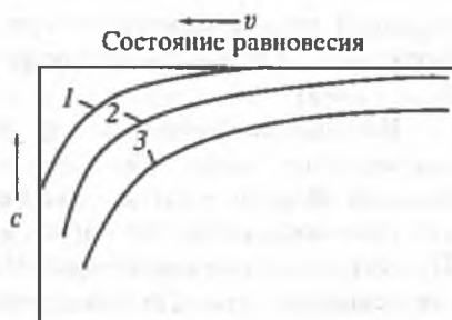
Рис. 2.15. Схема изменения степени насыщения подземных вод различными соединениями ( c ) в зависимости от скорости их движения
