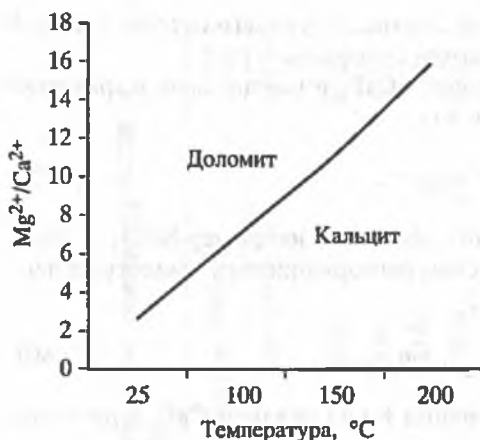
Рис. 2.8. Изменение отношения активностей a_{Mg^{2+}}/a_{Ca^{2+}} в водном растворе, равновесном с минеральной ассоциацией кальцит + доломит, при изменении температуры и давления вдоль кривой насыщенного пара воды
