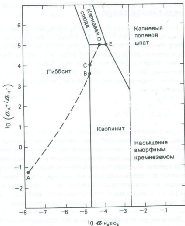
Р и с. 14.2. Изменение состава раствора (ABCDE) в процессе реакции калиевого полевого шпата с водой, изображенное на диаграмме устойчивости минералов (по Хелгесону и др. [155]).
