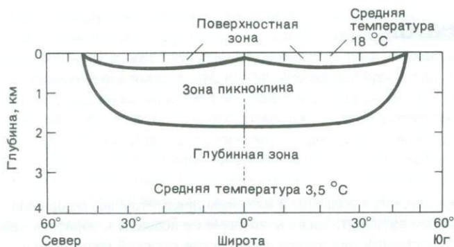
Р и с. 10.1. Схематическая диаграмма слоистой структуры океана и относительного объема каждой зоны. Заметьте, что "глубинная" зона вблизи полюсов подходит к поверхности (по Гроссу [140]).
