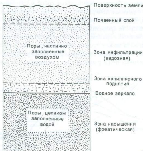
Р и с. 1.9. Терминологическая характеристика приповерхностной зоны проницаемых водоносных пород.
