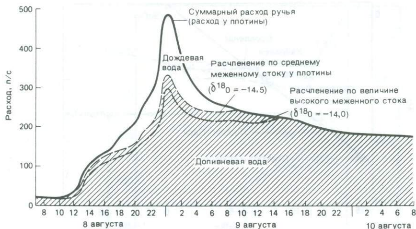
Р и с. 15.4. Сток Уилсон-Крик, расчлененный на дождевую воду и доливневой сток по данным по ^{18}\text{O} . Пунктирная линия показывает, как сказываются различные предположения об изотопном составе доливневой воды (по Фрицу и др. [115]).
