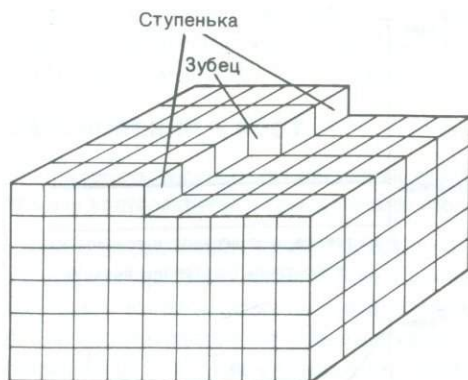
Р и с. 6.7. Модель поверхности кристалла, иллюстрирующая ступеньку и зубец. Каждый кубик соответствует молекуле, атому или паре ионов (по Бернеру и Морзе [29]).
