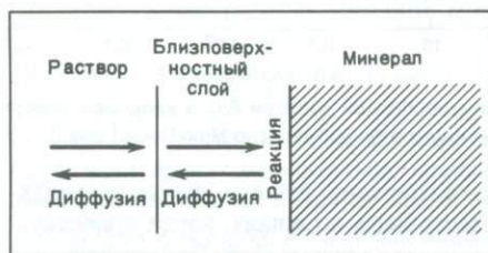
Р и с. 6.5. Схема взаимодействия минерала с раствором. Шагом, определяющим скорость процесса, могут быть реакция на поверхности минерала, диффузия через слой твердого осадка на поверхности зерен или диффузия в растворе.
