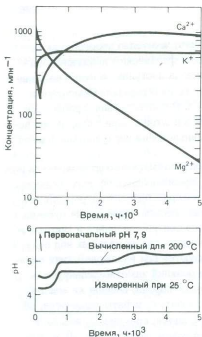
Р и с. 10.5. Изменение состава морской воды при ее нагревании с базальтом при температуре 200°C и давлении 500 бар (по Бишоффу и Диксону [30]).
