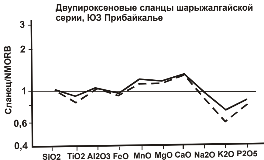
Рис. 14.1 Средние составы двупироксеновых сланцев шарыжалгайской серии, нормированные по современному океаническому базальту (NMORB). Архейские сланцы обогащены MnO, MgO, CaO и обеднены TiO 2 и K 2 O.
