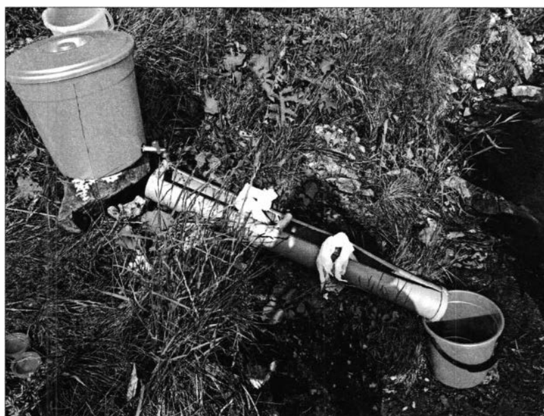
Рис. 2.9. Натурный эксперимент по дренированию вещества отходов природной водой.
