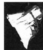
Каймы растворительного замещения сульфидов: галенита – англезитом и ковеллином, сфалерита – Fe-Cu-сульфидом
