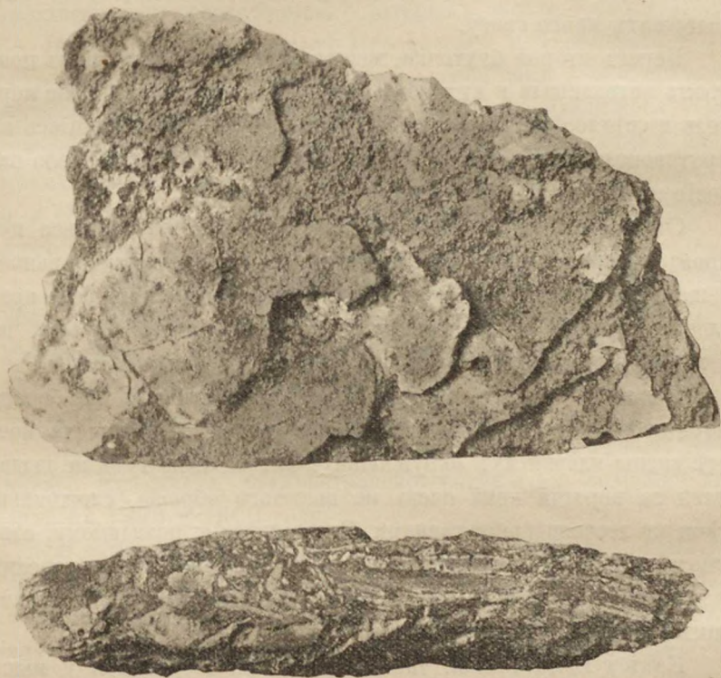
Рис. 7. Кусокъ своеобразнаго конгломерата кусочковъ мергеля, скрѣпленныхъ оолитовымъ цементомъ съ примѣсью глины. Поповъ камень. Наверху видъ съ поверхности, внизу въ поперечномъ разрѣзѣ (надшлифованномъ). Нѣсколько менѣе натуральной величины.
