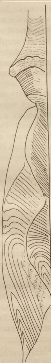
Рис. 3. Схематическое изображеніе забрасыванія пластовъ въ юговосточномъ крылѣ антиклинали горы Зеленецкаго. На- право (тоненькими черточками) свѣтлыя сланцевыя глины с. Круто стоящій пластъ изогнутой вправо — среднесарматскіе мергели, (см. фототипию, табл. III) центр антиклинали — нижнесарматскія темныя сланцевыя глины. Въ трехъ мѣстахъ (въ преувеличенныхъ размѣрахъ) показано «Hakenwerfen».
