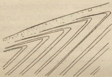
Рис. 4. Забрасываніе пластовъ при одностороннемъ паденіи пластовъ и склона.
