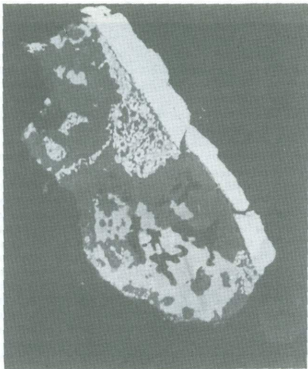
Рис. 5. Соотношение крупных и эмульсионных выделений рутениридосмина ( \text{Os, Ir, Ru} ) (белое) с оловосодержащим минералом (\text{OsRuIrSn})\text{S}_2 ряда лаурит-эрликманит (светло-серое); темно-серое – лаурит \text{RuS}_2 ; черные неправильной формы выделения – ромбический пироксен. Обр. А-43-2, Думбэрэльский массив, увел. 1100, в отраженных электронах
