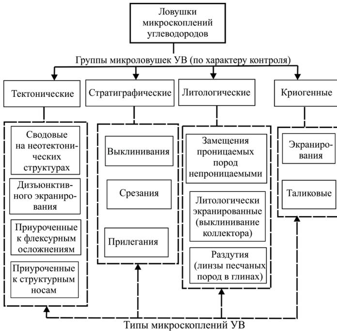
Рис. 12.1. Ловушки микроскоплений углеводородов зоны геохимических поисков методами ГПНГ (по А. К. Битнеру, 1987)
