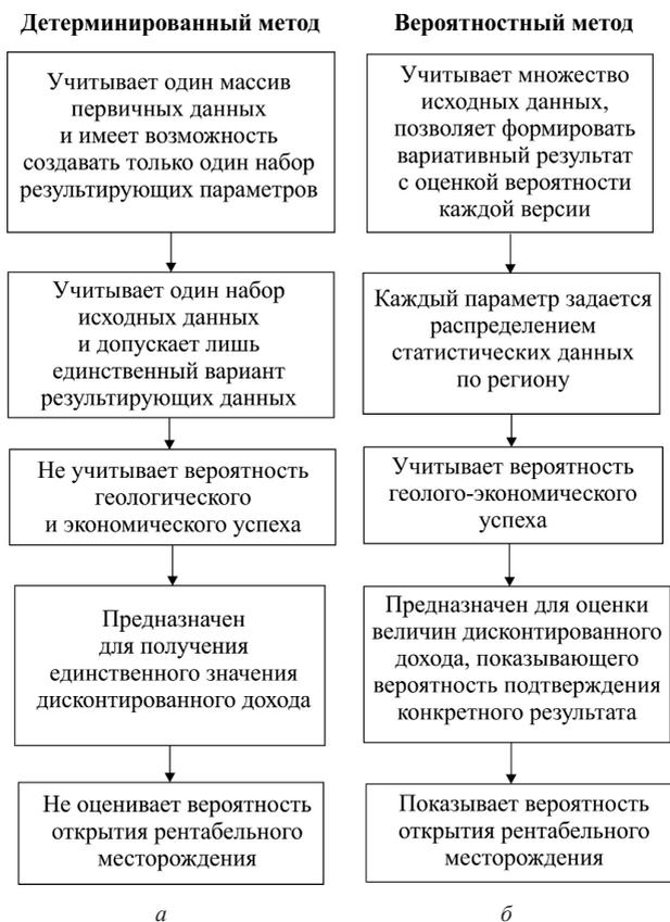
Рис. 4.5. Отличия детерминированной (а) и вероятностной (б) оценок
