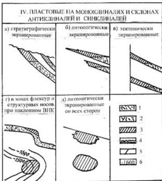
Рис. 11.4. Классификация залежей нефти и газа по типам резервуаров и ловушек. Составил Е. М. Максимов
